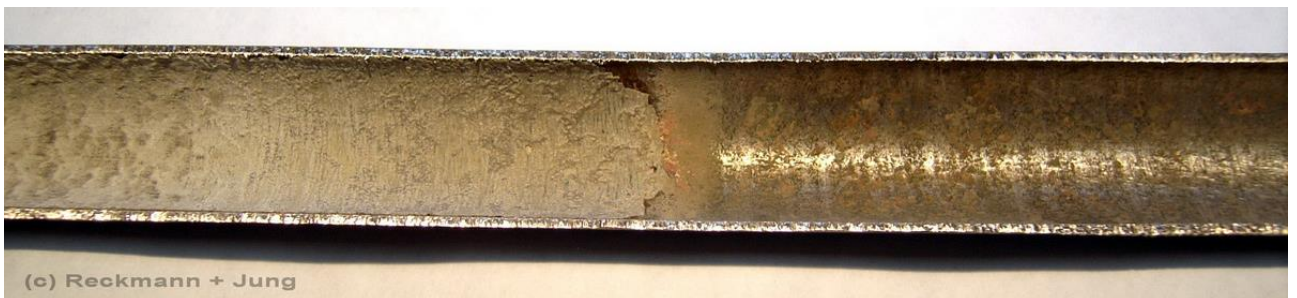
Entfernung von Kalziumkarbonat-Ablagerungen ohne Chemie
